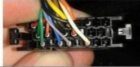
Se basear sempre pela posição dos fios no conector, e não pelas cores dos fios no veículo, depende do ano mudam as cores dos fios.
